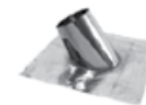
Krovni opšav 26°-35° + s olovnim rubom i obruč. protiv padalina/ DWECO - 38
