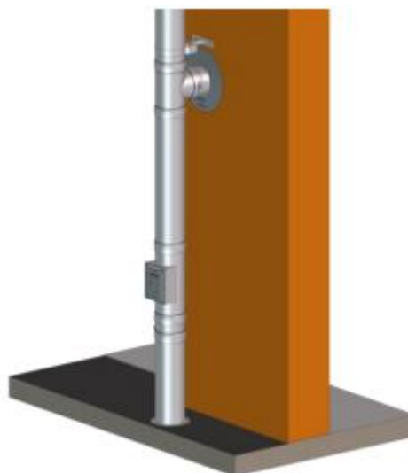
slika 5-8: montaža sa teleskopskim potpornjem
