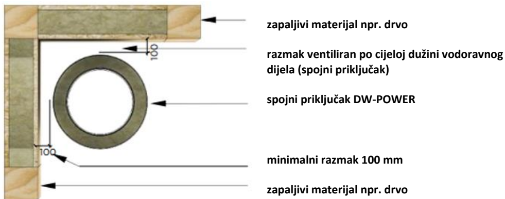
slika 4-3: ugradnja kao spojni priključak do T600
