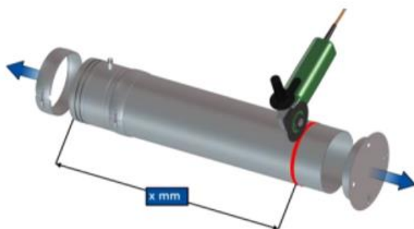
slika 5-8: skraćivanje teleskopskog potpornja
