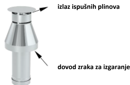
slika 27 a: završetak dimnjaka (terminal)
