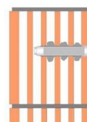
sl. 3 primjer, učvršćenje u zidu sa injekcijskim sidrištem
